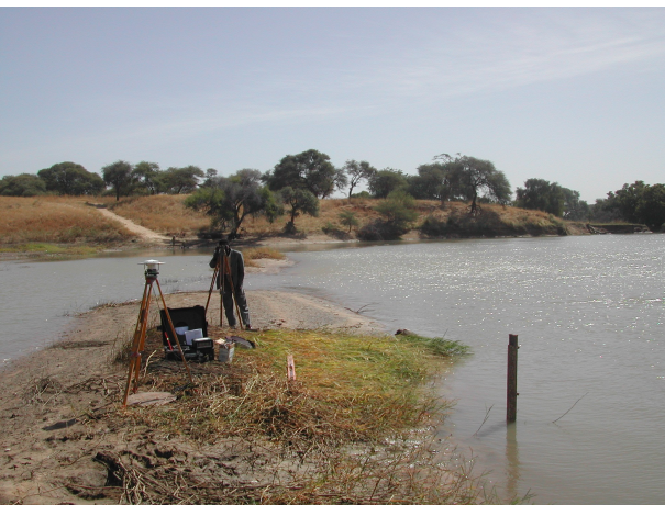
nivellement et acquisition GPS à l'échelle de Chefouri sur la Komadougou
