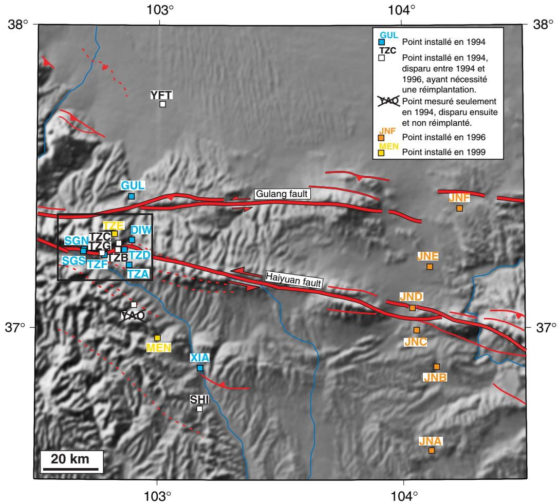
FIG. 3.4: Carte des deux profils GPS implantés : à l'ouest, le profil de Tianzhu, à l'est, le profil de Jingtai. Le cadre noir indique l'emplacement de la figure 3.5.
