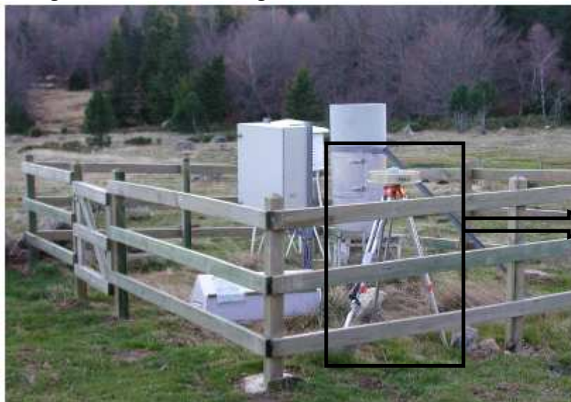
GPS-Antenne auf einem Dreibein
